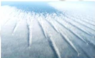
Visualisierung aerodynamischer Nachlaufeffekte von WKA in Form von Winddefizitkanälen und Rotorturbulenzen. Quelle: BWLV
